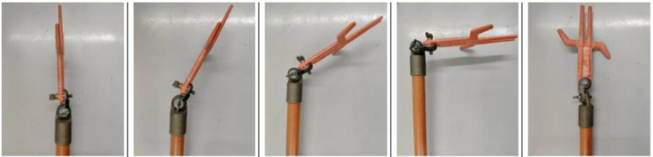
Figura 3: Adaptador universal aplicado ao cabeçote polimérico.
