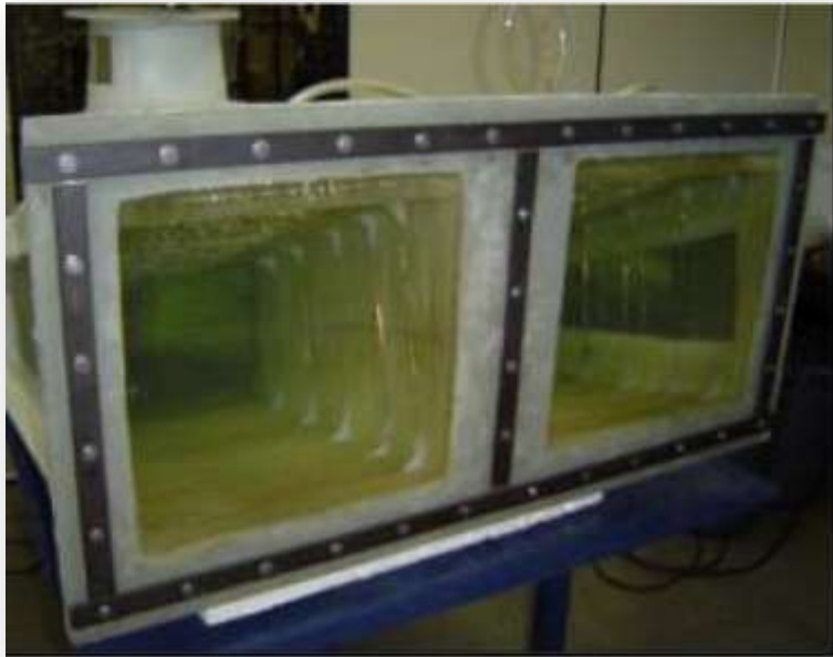
Figura 62. Protótipo do canal de fuga
