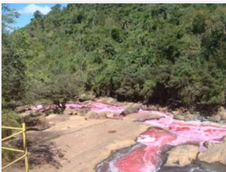
Figura 119. Água corada com traçadores a jusante da PCH Paciência
