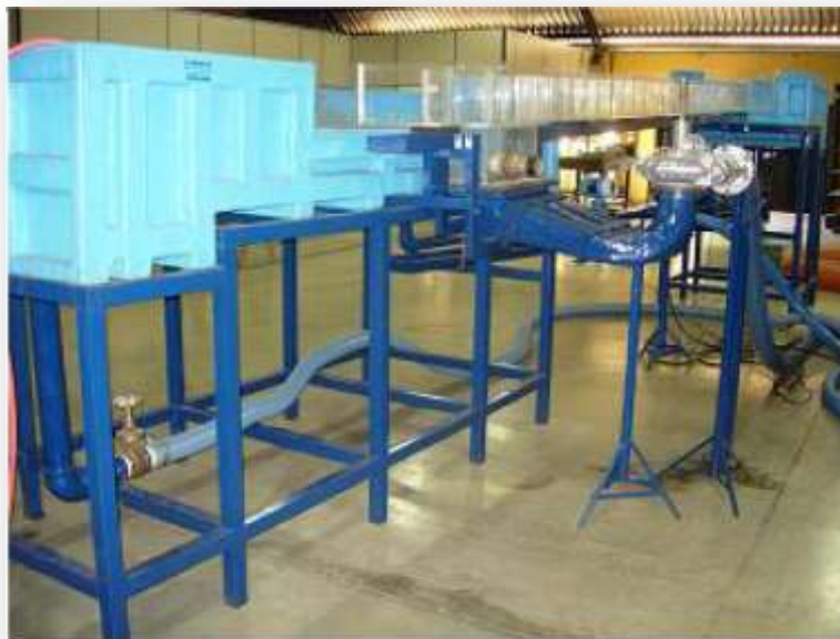
Figura 54. Projeto experimental de escada para peixes
