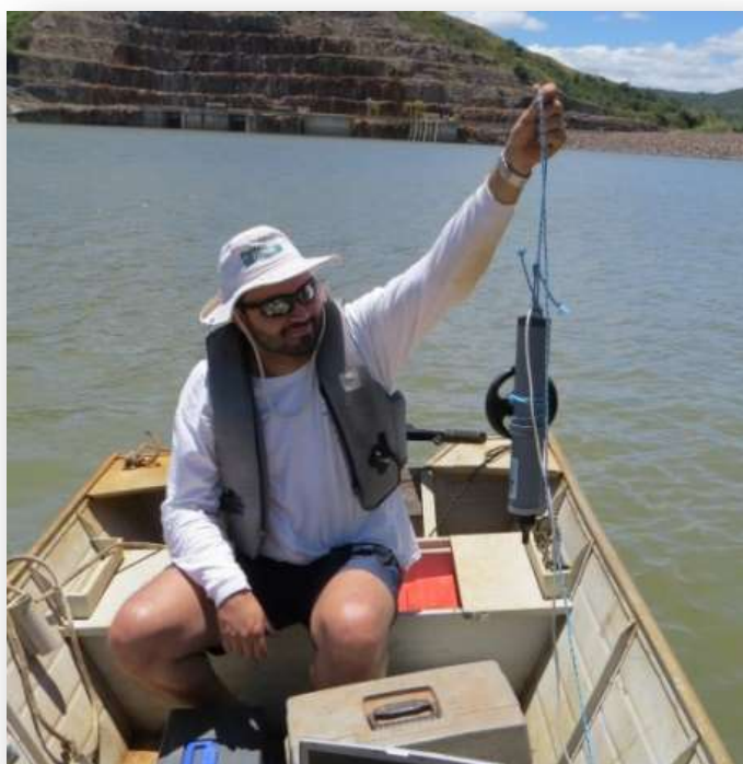
Figura 58. Testes com equipamentos para rastreamento dos peixes
