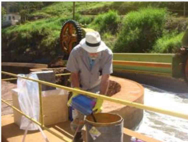
Figura 118. Aplicação dos traçadores para avaliação da descarga de fundo da PCH Paciência
