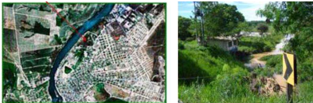
Figura 8 - Bairro Lagoa, município de Pirapora, início de inundação com vazões de 2.800 m 3 /s
