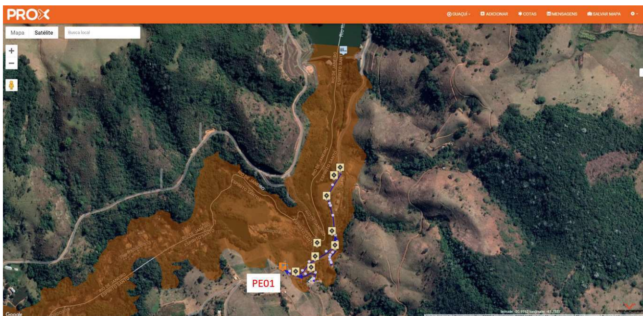
Figura 10 - Localização das placas de sinalização de alerta das Rotas de Fuga e dos Pontos de Encontro no PROX - Guaçuí/ES.
