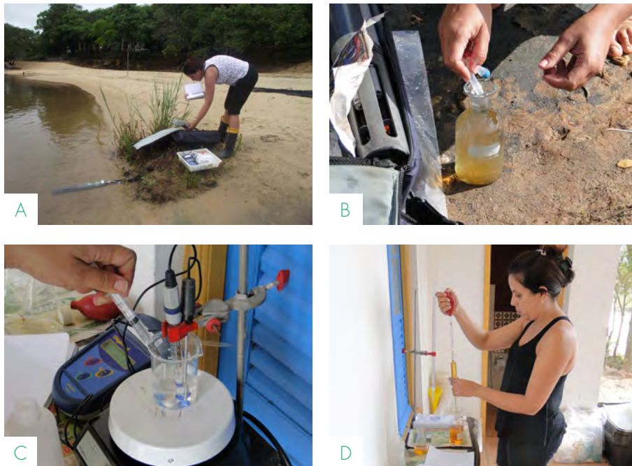
FIGURA 4 – Determinação de variáveis físicas e químicas na coluna d'água in situ (A), fixação de amostras de água para determinação de oxigênio dissolvido (B), mensuração em laboratório montado no local (C) e (D) - Fonte: Os autores (2020).
