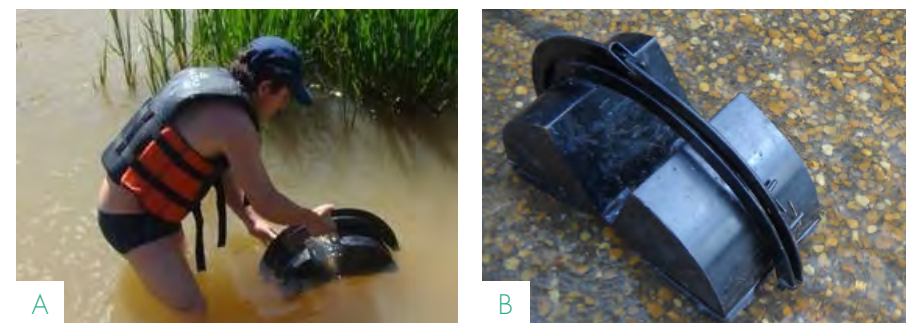
FIGURA 6 – Amostragem de sedimento para determinação da comunidade de macroinvertebrados bentônicos: coleta local com draga de Petersen (A) e detalhe da área do sedimento amostrado pela draga (B) - Fonte: Os autores (2020).
