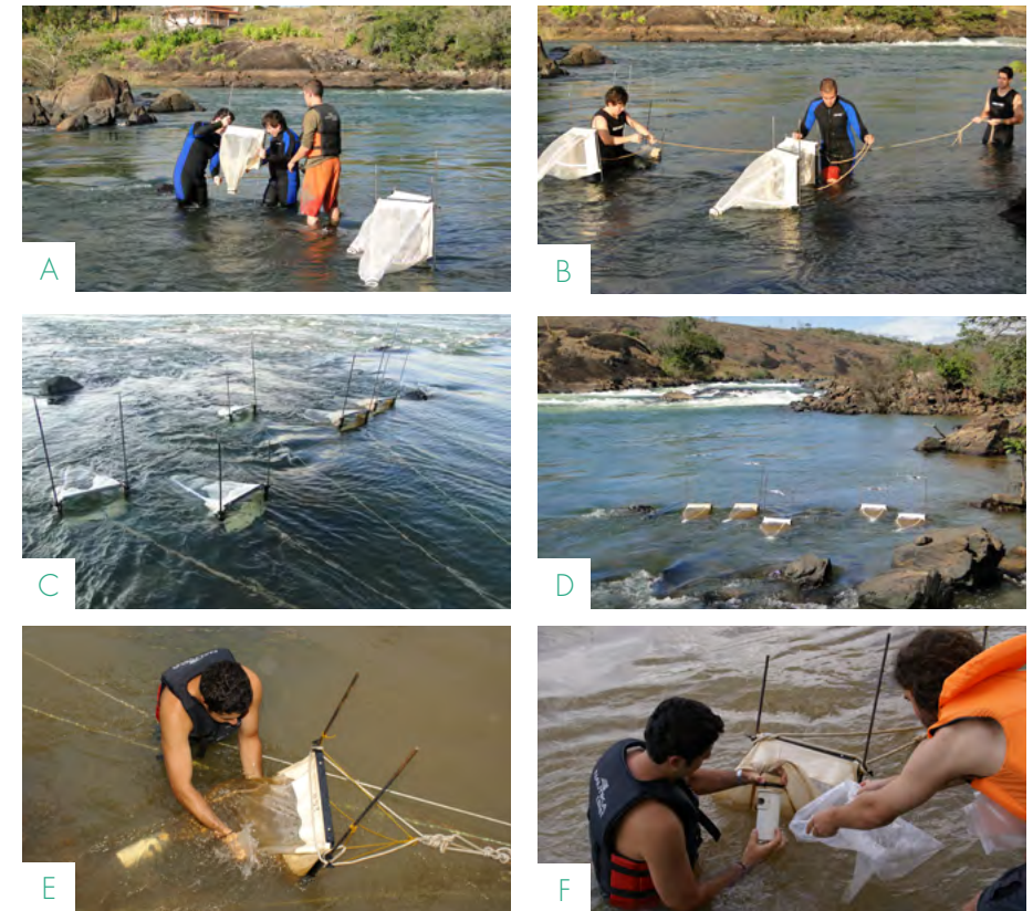
FIGURA 8 – Montagem e fixação das redes de drift (A-D) na margem direita do Rio Grande, a jusante da UHE Itutinga; procedimento de coleta dos macroinvertebrados retidos nas redes de drift (E-F) - Fonte: Os autores (2020).
