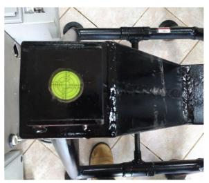
O cavalete é fabricado em tubos de aço sem costura, articulado com sistema de travamento de abertura e indicador de inclinação de trabalho. Tem capacidade carga nominal para suportar até 2t e pode ser utilizado em postes DT até 13m 600 daN e SC até 13m 1000 daN.
