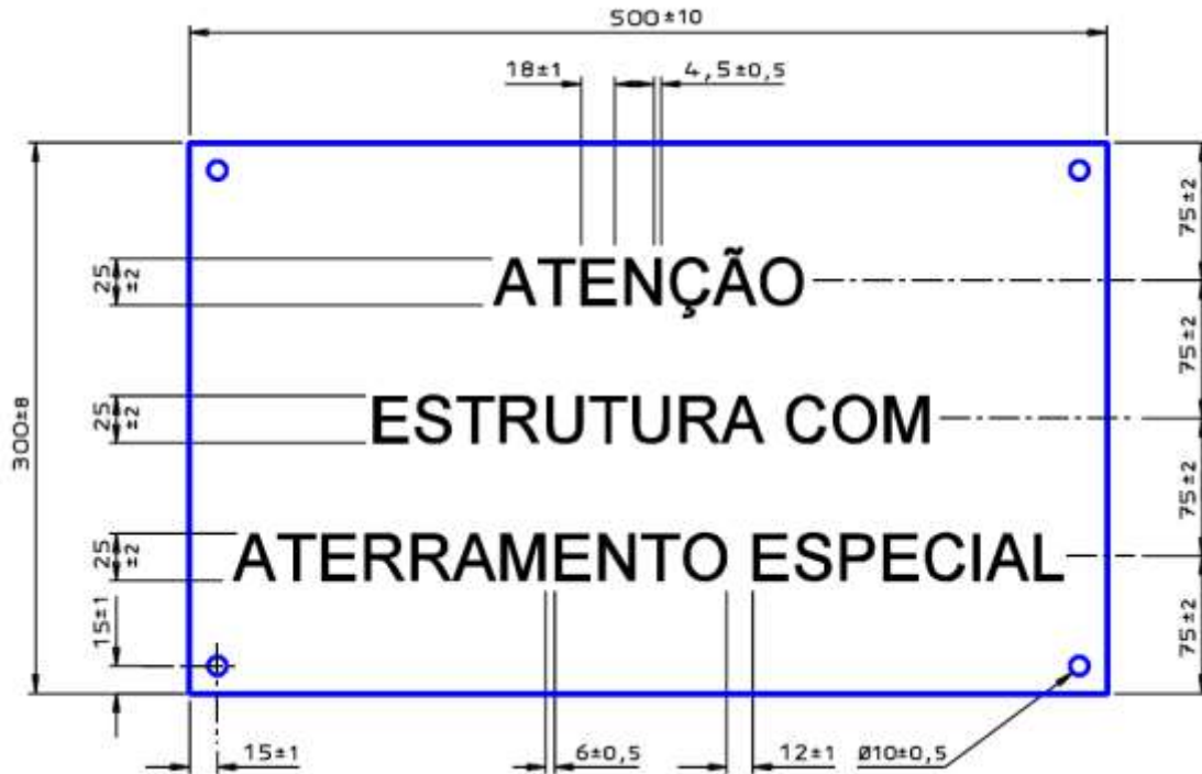
Figura 8. Placa de Advertência – ATENÇÃO – ESTRUTURA COM ATERRAMENTO ESPECIAL (02.118-CEMIG-670)
